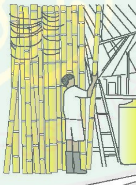
Gambar 2. 13. Pengikatan Bambu (sumber: Garland, 2013)
